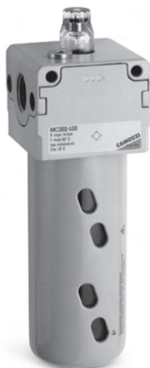
Доступны маслораспылители Серии MC с присоединением G1/4, G3/8 и G1/2. Стаканы этих маслораспылителей сделаны из металла с окошками из прозрачного стекла. Процесс маслораспыления можно наблюдать через небольшой прозрачный колпачок в верхней части маслораспылителя, а регулировка интенсивности осуществляется специальным винтом.
