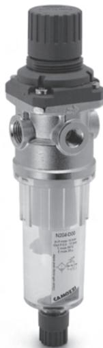
Фильтры-регуляторы Серия N поставляются с присоединительными размерами G1/4 и G1/8. Регулятор имеет мембрану и сброс выходного давления, превышающего уровень настройки. Прозрачный стакан фильтра позволяет контролировать уровень конденсата. Фильтры-регуляторы серии N оснащены полуавтоматическим клапаном слива (реагирует на падение давления на входе ниже 0,3 бар при отключении компрессора в конце смены). Полуавтоматический клапан слива имеет также ручной режим.
